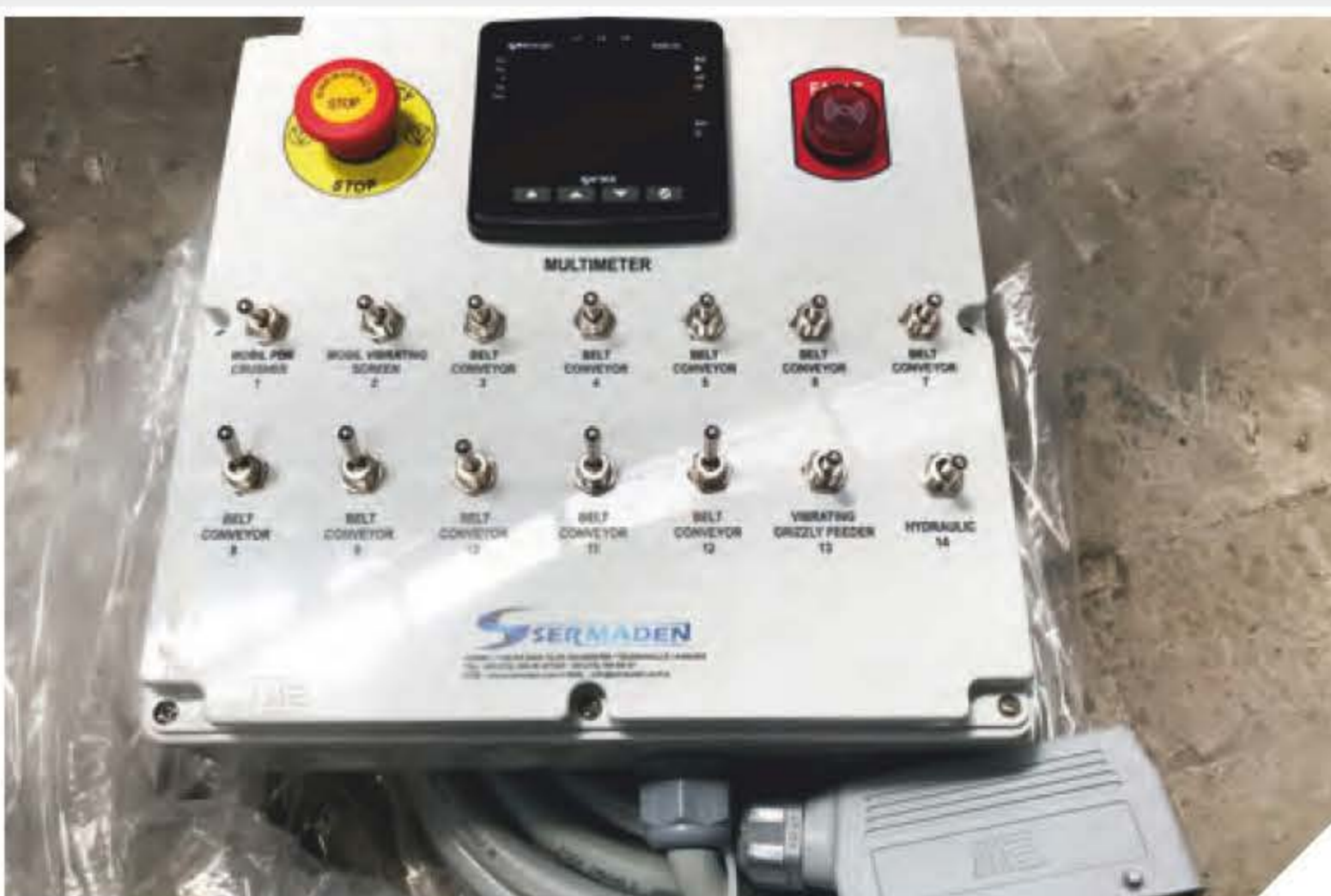
Мобильная Установка: Пульт Управления
